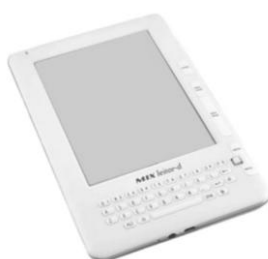
Figura 19 – Leitor-D . Fabricante: Mix Tecnologia e Carpe Diem Edições e Produções (Brasil). Tamanho da tela: 6". Peso: 260 gramas. Fonte: Yano, 2010a.
