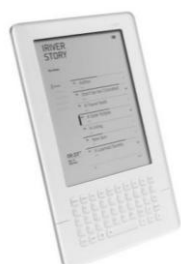
Figura 23 – iRiver Story . Fabricante: iRiver (Coreia do Sul). Tam. da tela: 6". Peso: 284 gramas. Fonte: Yano, 2010a.
